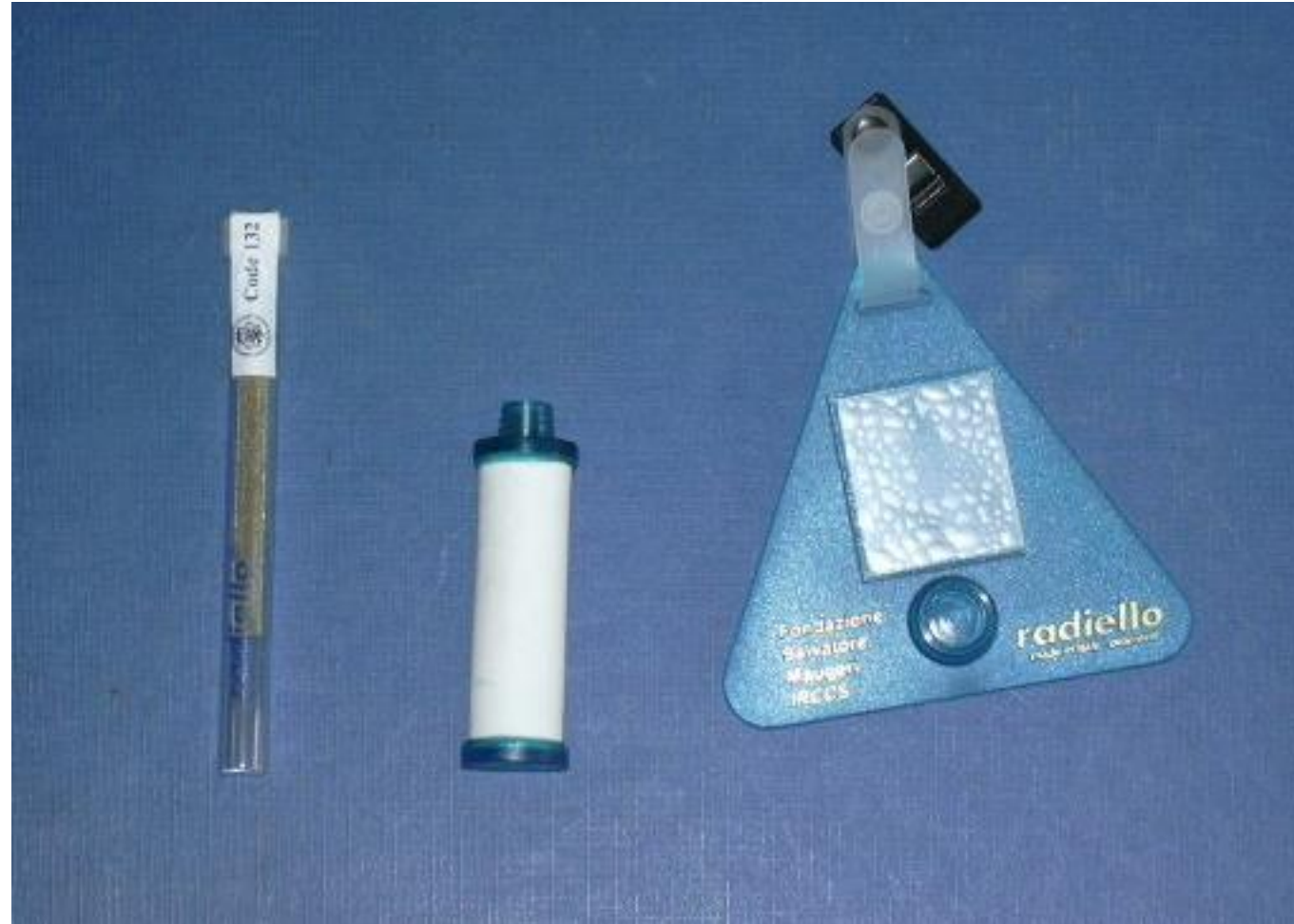
CAMPIONATORE PASSIVO RADIELLO® PER SOLVENTI retinatura in policarbonato; substrato carbone attivo
