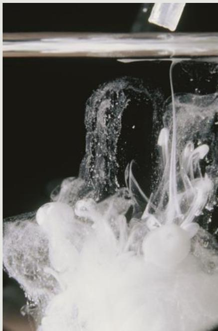
L'aggiunta di una soluzione contenente ioni cloruro ad una soluzione satura di cloruro di argento fa diminuire ulteriormente la solubilità del sale e determina ancora precipitazione.
