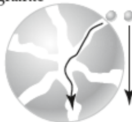
FIGURA 20.14 Processi di allargamento delle bande che possono verificarsi in cromatografia.
